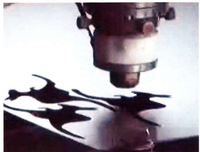
Laser w czasie pracy – prezentacja w Centrum Laserowych Technologii Metali
