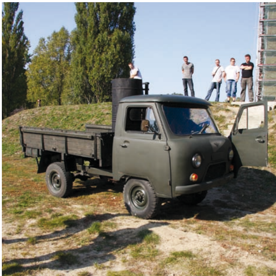
Ciężarówka z instalacją wytwarzającą gaz drzewny na „pokładzie”
